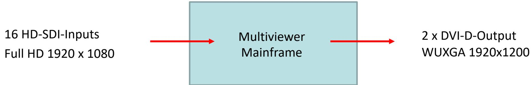
Es können maximal 16 verschiedene Bildquellen in einem Layout von der Multiviewer-Hardware dargestellt werden. Ein Video Processor und ein leistungsfähiger Scaler setzt die Eingangsquellen direkt zu einem neuen Ausgabebild zusammen. Die verschiedenen Display-Layouts können mit einer speziellen Software auf dem PC Video erstellt und als Presets abgespeichert werden.
