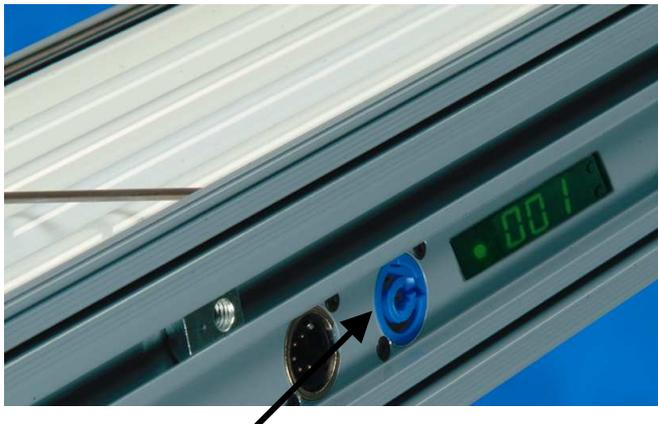
Stecken Sie den PowerCon-Steckverbinder dieses Kabels in die linke, blaue PowerCon-Steckvorrichtung der Master-Leuchte und drehen Sie den Steckverbinder um ca. eine ¼-Umdrehung nach rechts, bis die Verriegelung des Steckers hörbar einrastet. Stecken Sie den Netzstecker dieses Kabels jedoch noch nicht in eine unter Spannung stehende Steckdose, da noch keine Zuführung der Netzversorgung
